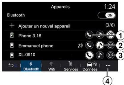
Para aceder à música, lista telefónica e ligação à Internet do seu telefone através do sistema multimédia, será necessário autorizar a partilha de dados utilizando o menu "Telefone" e, em seguida, o menu contextual, "Lista equi. Bluetooth Bluetooth®".
