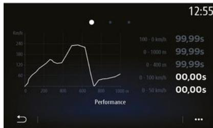
A medição da performance é automática e começa quando for detetada uma velocidade superior a 0 km/h. É reiniciada automaticamente depois de uma paragem superior a dois segundos. A medição da desaceleração tem início durante uma travagem significativa.
