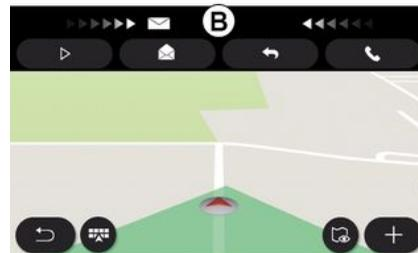
O sistema multimédia informa o condutor da receção de uma nova SMS através de uma mensagem de aviso em **B** apresentada em qualquer menu que esteja aberto.
