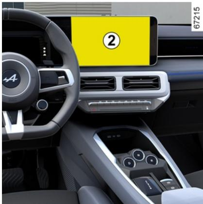
No ecrã multimédia 2, quando a marcha-atrás estiver engrenada, pressione o botão "Definições" para adicionar ou remover guias e ajustar as definições de imagem da câmara (brilho, contraste, etc.). Para mais informações, consulte o manual do sistema multimédia.
