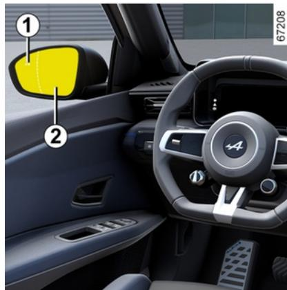
Quando uma porta é aberta e é detetado um objeto em movimento, o testemunho **1** aparece no retrovisor exterior **2** e, consoante o veículo, as luzes ambiente na porta dianteira acendem-se.
