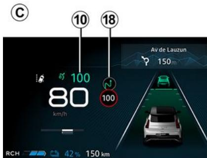
Utilizando a câmara, a função "Deteção de sinais de trânsito" → **238** e os mapas, o sistema pode antecipar e gerir a adaptação automática da velocidade de regulação **10** quando o veículo se aproxima
