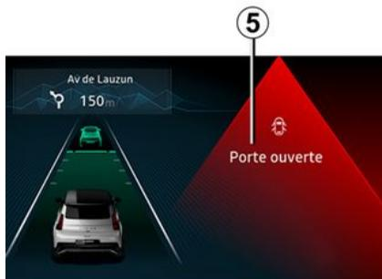
Com o veículo imobilizado e a ignição ligada, o testemunho
