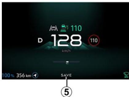
**i** Com o modo Save ativado, o testemunho Save **5** é apresentado no quadro de instrumentos. A velocidade do veículo está limitada a aproximadamente 130 km/h. Em andamento, é possível sair temporariamente do modo Save de modo a melhorar o rendimento do motor. Para tal, carregue com firmeza no pedal do acelerador a fundo. O modo Save é reativado quando alivia a pressão no pedal de acelerador.
