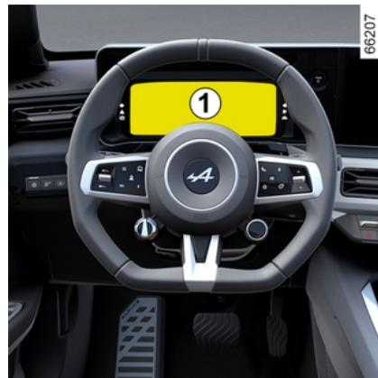
Se o sistema detetar uma falha relacionada com a pressão dos pneus, será apresentada uma mensagem de aviso no quadro de instrumentos 1.
