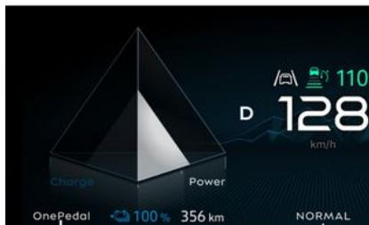
Com a posição **D** selecionada, rode o comando **2** na direção de **A** as vezes necessárias até a mensagem "One Pedal ativado" ser apresentada. O testemunho ONE PEDAL **3** acende-se, acompanhado de um sinal sonoro, para confirmar que a função está ativada.
