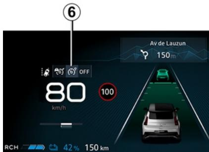
**i** Para sair da ajuda à condução, prima o interruptor **1** as vezes necessárias até aceder a OFF. A mensagem "Ajuda à condução desativada" é apresentada no quadro de instrumentos. Neste caso, na próxima vez que o motor for ligado, a função do "Limitador de velocidade" será ativada e aguardará a memorização de um limite de velocidade.
