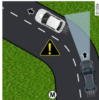
Ao entrar numa curva, o radar e/ou a câmara poderão não conseguir detetar temporariamente o veículo mais à frente (por exemplo, **M**).
