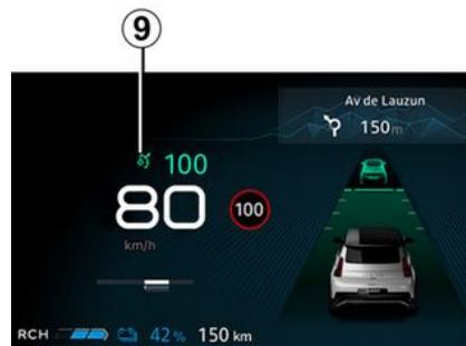
O radar é capaz de detetar o veículo que circula à sua frente. O sistema pode não funcionar corretamente se a zona de deteção do radar estiver tapada ou se o sinal for interrompido.
