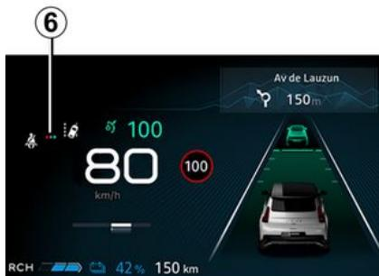
Com as portas fechadas, o gráfico 6 é apresentado no quadro de instrumentos durante aproximadamente 60 segundos quando a ignição do veículo é ligada. Isto informa sempre o condutor se o cinto de segurança de cada um dos lugares dianteiros está ou não encaixado:
