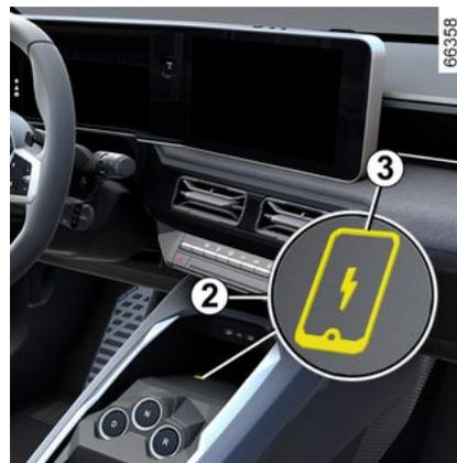
Consoante o veículo, o símbolo 3 indica que a zona pode 2 ser utilizada para carregar o seu telemóvel sem utilizar um cabo de carga.
