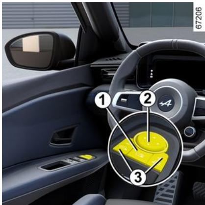
Quando seleccionar um retrovisor exterior através de um dos interruptores **3**, será apresentado o testemunho integrado no interruptor. Em seguida, utilize o botão **2** para regulá-lo para a posição pretendida.
