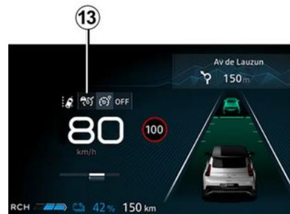
Prima o interruptor 3 para seleccionar o regulador de velocidade adaptativo em 13. O testemunho 9 é apresentado a cinzento. A mensagem "Regulador adaptativo
