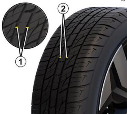
Os pneus devem estar em bom estado e os sulcos devem apresentar-se com profundidade suficiente; os pneus homologados pelos nossos serviços técnicos incluem avisadores de desgaste **1** que são **constituídos por bossas-testemuradas**
