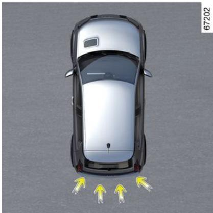
Além da função "Assistente de estacionamento." → 285 e as informações dos quatro sensores centrais situados na traseira do veículo, o sistema deteta obstáculos fixos situados por trás do veículo. Se existir um risco de colisão significativo, o sistema trava o veículo automaticamente.
