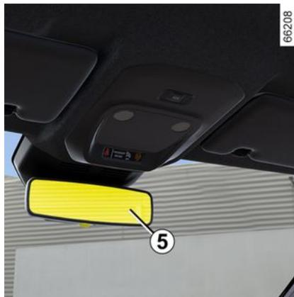
O retrovisor escurece-se automaticamente para não ser encandeado pelos máximos de um veículo que o siga ou em caso de forte luminosidade.
