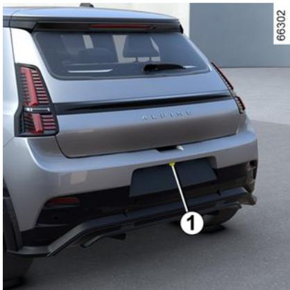
Quando a marcha-atrás é engrenada, a câmara **1** situada na traseira do veículo transmite uma vista da zona por trás do veículo no ecrã multimédia **2**, acompanhada de uma a três guias **3 4** ou **5** (fixa, móvel e atrelado).
