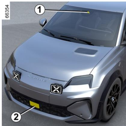
Utilizando as informações do radar 2 e da câmara 1, esta função informa o condutor sobre o intervalo de tempo que o separa do veículo que segue à sua frente, de modo a que seja possível manter uma distância de segurança entre os dois veículos.
