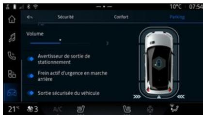
Para ativar ou desativar a função através do ecrã multimédia 1, selecione o mundo "Veículo" e, em seguida, "Assistente de condução" e, em seguida, "Estacionamento". Ative "Sistema de travagem de emergência ativa em marcha-atrás".
