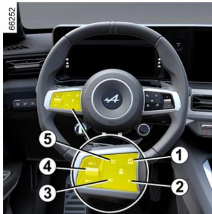
A função do limitador de velocidade é suspensa ao premir o interruptor 2 (0).
