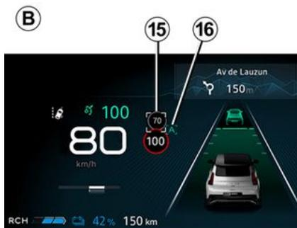
Utilizando a câmara, a função "Deteção de sinais de trânsito" → 238 e os mapas, o sistema antecipa a adaptação automática da velocidade do veículo até o sinal de limite de velocidade seguinte ser identificado **15** e passado.
