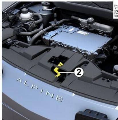
Para desbloquear, empurre a alavanca **2** para a esquerda enquanto levanta o capô.
