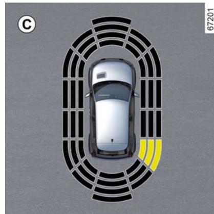
O sistema é capaz de detetar a maioria dos objetos existentes perto da traseira e, consoante o equipamento, perto da dianteira e das partes laterais do veículo.
