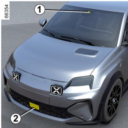
Utilizando informações provenientes da câmara 1 e do radar 2, o sistema determina a distância entre o seu veículo:
