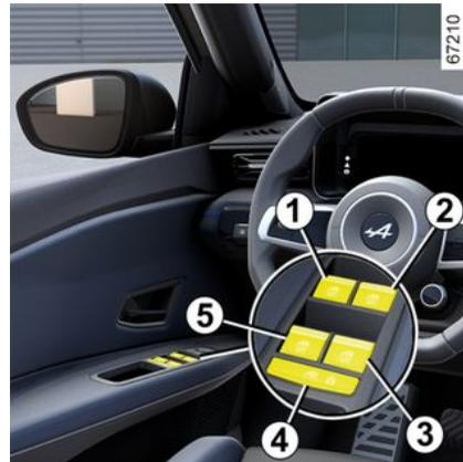
Pressione ou puxe brevemente um interruptor do vidro até ao limite: o vidro subirá ou descerá completamente. Uma ação no contactor interrompe o movimento do vidro.
