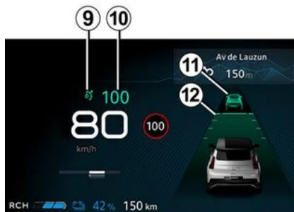
9. Testemunho do regulador de velocidade adaptativo Stop and Go.
