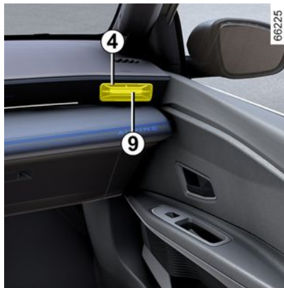
Rejillas de ventilación del pasajero 4
