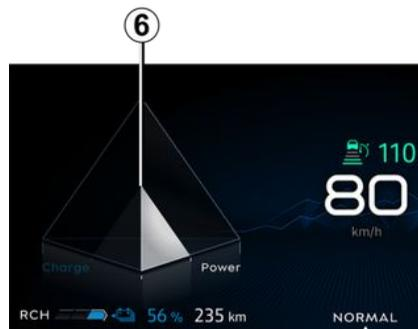
Medidor de energía 6
