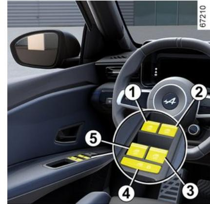
Pulse brevemente el mando de un elevallas o tire de él hasta el máximo posible: el cristal subirá o bajará totalmente. Una acción sobre el mando detiene el desplazamiento del cristal.
