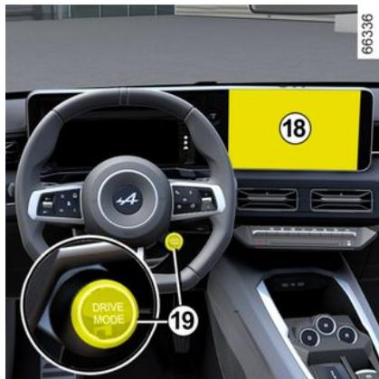
En el menú MODO DE CONDUCCIÓN, al que se accede desde la pantalla multimedia **18** o presionando el interruptor **19**, puede activar el modo Save que afecta al nivel de calefacción y reduce el consumo de carburante del vehículo.
