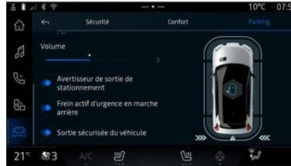
Para activar o desactivar la función mediante la pantalla multimedia 1, seleccione el mundo "Vehículo", a continuación "Asistente a la conducción" y luego "Aparcamiento". Active el "Frenado activo de emergencia en marcha atrás".
