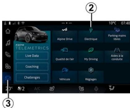
Con el vehículo detenido y el motor en marcha, desde Mundo "Vehículo" **3** en la pantalla multimedia **1**, presionar el menú "Eléctrico" **2** y, a continuación, la pestaña "Carga y clima" para configurar la carga del vehículo.
