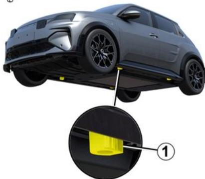
El vehículo está equipado con cuatro puntos de elevación específicos **1** situados debajo de este.
