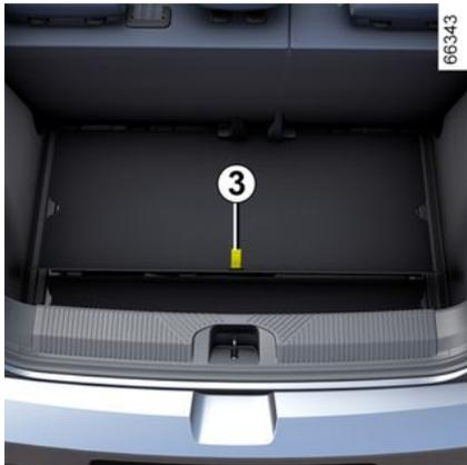
Según el vehículo, la bandeja sirve para guardar los cables de carga. La carga máxima admisible de la bandeja es de 10 kg.
