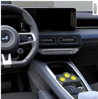
Los botones **R**, **N** y **D** se pueden utilizar para engranar distintas posiciones en la caja de velocidades:
