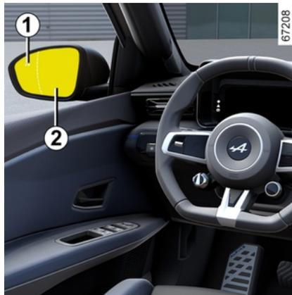
Cuando se abre una puerta y si se detecta la presencia de un objeto en movimiento, se muestra la luz de advertencia **1** en el retrovisor exterior **2** y, según el vehículo, se encienden las luces de ambiente de la puerta delantera.
