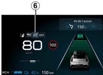
**i** Para salir de la asistencia a la conducción, pulse el botón **1** las veces necesarias hasta llegar a OFF. Se muestra el mensaje "Driving Assistance deactivated" en el cuadro de instrumentos. En este caso, la próxima vez que se arranque el motor, se activará la función "Limitador de velocidad" y va a permanecer a la espera de que se memorice una velocidad máxima.
