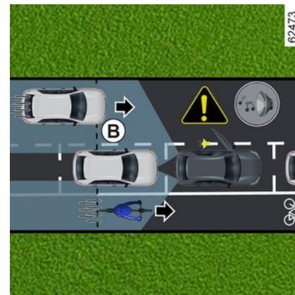
A partir de la información procedente de los sensores instalados a cada lado del paragolpes trasero (zona **C**), la función advierte al conductor:
