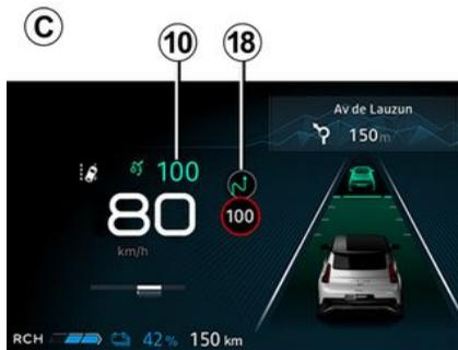
Utilizando la cámara, la función de detección de señales de tráfico ➔ **235** y la cartografía, el sistema puede prever y gestionar la adaptación automática de la velocidad
