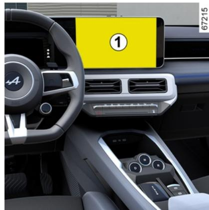
Con el vehículo parado y el motor encendido, desde Mundo "Vehículo" **3**, en la pantalla multimedia **1**, presionar el menú "Eléctrico" **2** y, a continuación, la pestaña "Carga y aire acondicionado" para tener acceso a los ajustes.
