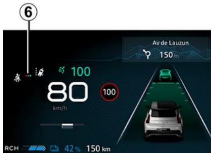
Con las puertas cerradas, el gráfico 6 aparece en el panel de instrumentos durante aproximadamente 60 segundos al poner contacto. De este modo se informa al conductor del estado de cada uno de los cinturones de seguridad delanteros cada vez:
