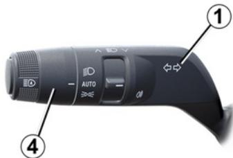
Esta función permite encender momentáneamente las luces de posición y las luces de cruce (por ejemplo, para iluminar la apertura de una puerta de acceso).
