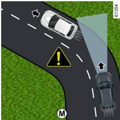
Al entrar en un giro o curva, el radar o la cámara podrían no ser capaces de detectar temporalmente a un vehículo que circula por delante (por ejemplo, **M**).
