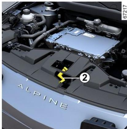
Para desbloquearlo, empujar la palanca **2** hacia la izquierda al mismo tiempo que se levanta el capó.
