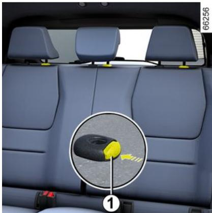
Inclinar la banqueta hacia adelante, levantar el reposacabezas al máximo, a continuación, presionar el botón **1** y extraer el reposacabezas.
