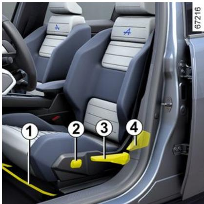
Levantar la empuñadura **1** para desbloquearlo. En la posición elegida, suelte la palanca y asegúrese de que queda bien bloqueado.
