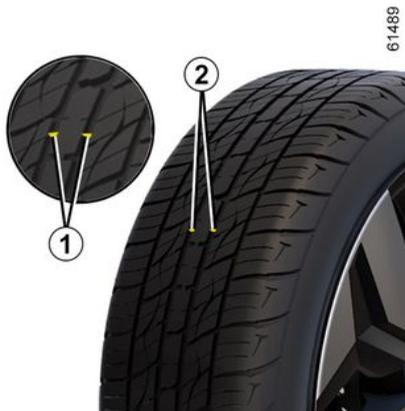
Los neumáticos deben estar en buen estado y sus dibujos deben presentar una profundidad suficiente; los neumáticos homologados por nuestros servicios técnicos
