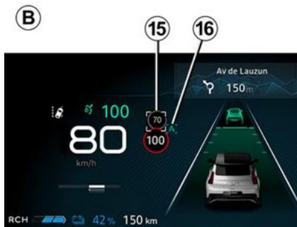
Mediante el uso de la cámara, la función de detección de señales de tráfico → 235 y el mapa, el sistema anticipa el ajuste automático de la velocidad del vehículo hasta que se identifica la señal o zona de velocidad limitada siguiente 15.
