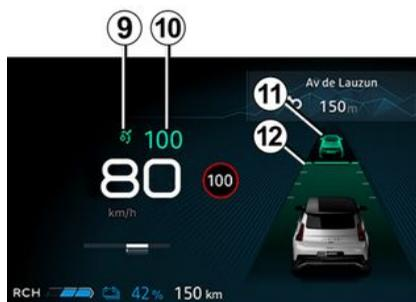
**9.** Stop and Go testigo del regulador de velocidad adaptativo.
