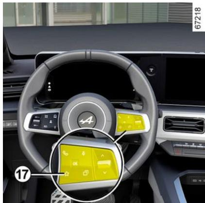
Según el vehículo, al presionar el mando del volante de dirección **17**, puede activar las siguientes funciones de acuerdo con los ajustes de usuario memorizados que haya definido previamente:
