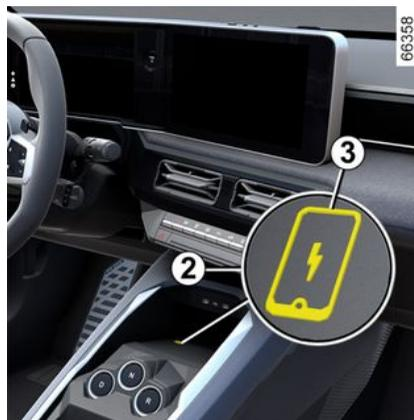
En función del vehículo, el símbolo **3** indica que el área **2** se puede usar para cargar su teléfono sin usar un cable de carga.
