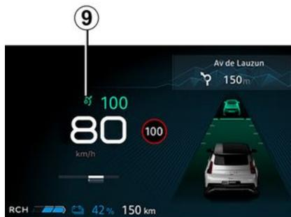
El radar es capaz de reconocer los vehículos que hay delante de su vehículo. El sistema no puede funcionar correctamente si la zona de detección del radar está tapada o si se interrumpe la señal.
