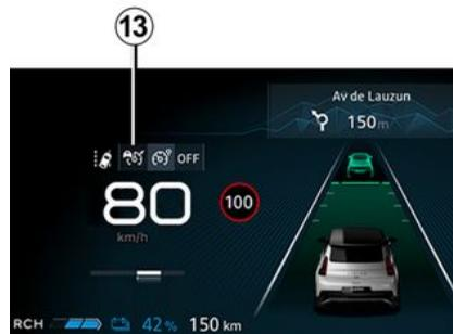
Presionar el botón **3** para seleccionar el regulador de velocidad adaptativo en **13**. Se muestra el testigo en color gris. El mensaje "Regulador adaptativo preparado: pulse SET para activar" aparece en el cuadro de instrumentos acompañado de guiones para indi-
