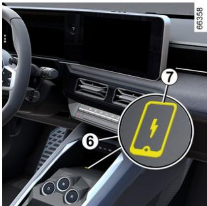
En función del vehículo, se muestra el símbolo **7** para indicarle que puede colocar el teléfono en la zona **6** para cargarlo sin necesidad de conectar un cable.
