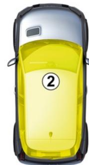
**Con el motor en marcha**, si la tarjeta no está ubicada en la zona **2** tras la apertura y cierre de una puerta, el mensaje "Tarjeta no detectada" indica que esta no se encuentra en el interior del vehículo. Esto permite evitar, por ejemplo, reanudar la marcha si un pasajero sale del vehículo llevándose la tarjeta.
