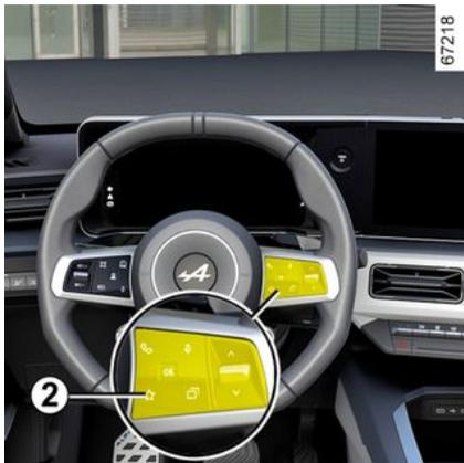
Según el vehículo, al presionar el mando del volante de dirección **2**, es posible activar las siguientes funciones de acuerdo con los ajustes de usuario memorizados que se hayan definido previamente:
