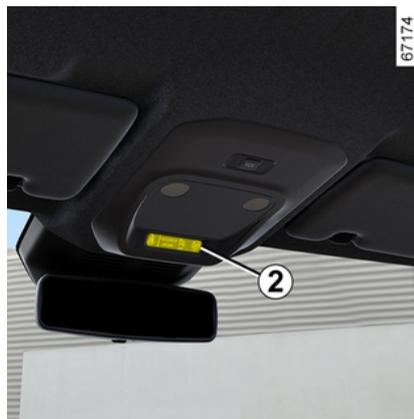
Para desactivar el airbag: con el vehículo parado y el contacto **apagado**, empujar y girar el cierre 1 a la posición OFF.
