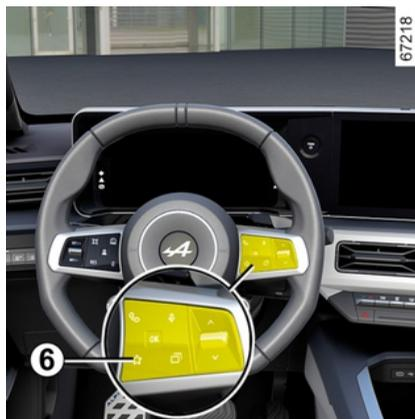
En función del vehículo, al presionar el mando del volante de dirección **6**, se pueden activar los asientos calefactables según los ajustes de usuario que se hayan definido previamente.
