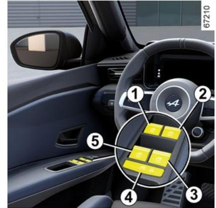
Drücken oder ziehen Sie einen Fensterheberschalter kurz bis an den Anschlag; Das Fenster wird vollständig geöffnet bzw. geschlossen. Durch nochmaliges Betätigen des Schalters können Sie den Vorgang unterbrechen.
