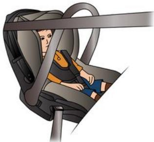
Der Kopf eines Säuglings ist im Verhältnis zu dem eines Erwachsenen schwerer und sein Hals ist empfindlicher. Transportieren Sie das Kind so lange wie möglich in dieser Position (mindestens bis zum Alter von 2 Jahren). Kopf und Hals werden hier gestützt.
