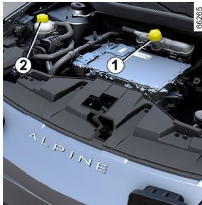
Je nach Fahrzeug kann die Lage der Kühlfüssigkeitsbehälter unterschiedlich sein:
