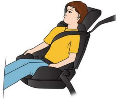
Ab einem Gewicht von 15 kg oder dem Alter von 4 Jahren kann ein Kind auf einer Sitzerrhöhung Platz nehmen, die eine Anpassung des Sicherheitsgurts an den Körper des Kindes ermöglicht. Das Sitzkissen der Sitzerrhöhung muss Beckengurtführungen aufweisen, damit der Sicherheitsgurt auf den Oberschenkeln und nicht am Bauch des Kindes verläuft. Damit der Gurt über die Mitte der Schulter verläuft, empfehlen wir die Verwendung einer Sitzerrhöhung mit
