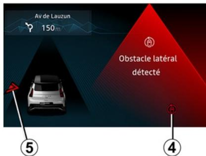
Wenn beim Fahren mit einer Geschwindigkeit zwischen etwa 70 km/h und 110 km/h die Gefahr eines Zusammenstoßes mit einem Fahrzeug besteht, das auf einer benachbarten Fahrspur und innerhalb des Erfassungsbereichs **C** aus der Gegenrichtung kommt, ohne dass der Fahrtrichtungsanzeiger aktiviert wurde, wird das System aktiviert:
