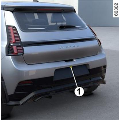
Wenn der Rückwärtsgang eingelegt wird, überträgt die Kamera **1** am Heck des Fahrzeugs auf dem Multimediaschirm **2** eine Ansicht auf den Bereich hinter dem Fahrzeug, begleitet von einer bis drei Maßlinien **3, 4** oder **5** (fest, beweglich und Anhänger-Orientierungslinien).
