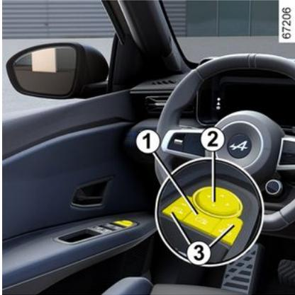
Wenn Sie einen Außenspiegel über einen der Schalter **3** anwählen, leuchtet die Kontrollleuchte im Schalter auf. Sie können dann die Taste **2** benutzen, um den Spiegel in die gewünschte Position zu stellen.
