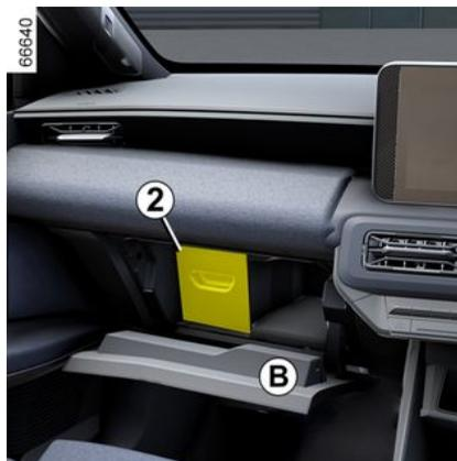
Die Sicherungen sind hinter dem Handschuhfach im Fahrgastraum **B** zugänglich. Das Handschuhfach mit der Öffnungstaste öffnen.
