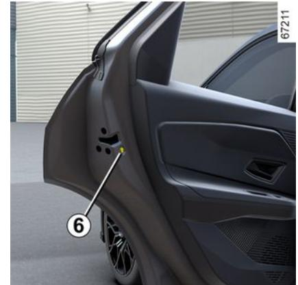
Um zu verhindern, dass die hinteren Türen von innen geöffnet werden können, senken Sie den Hebel 6 und überprüfen Sie von innen, ob die Türen sicher verriegelt sind.
