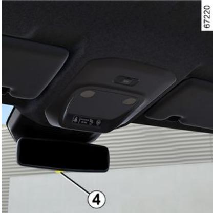
Um beim Fahren in Dunkelheit nicht von den Scheinwerfern des nachfolgenden Fahrzeugs geblendet zu werden, betätigen Sie den kleinen Hebel **4** hinter dem Rückspiegel.
