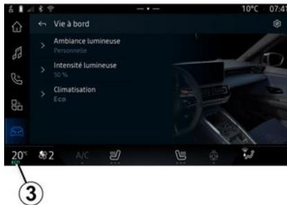
Dieser Parameter ist für jeden der DRIVE MODE-Modi verfügbar und ermöglicht es, die Reichweite des Fahrzeugs zu optimieren, indem auf die Leistung der Klimaanlage eingewirkt wird (z. B.: Verzögerung der Zeit, die erforderlich ist, um den gewünschten Temperatursollwert zu erreichen usw.) ➔ 189.
