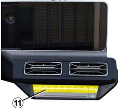
Zum Regulieren des Luftstrom aus den Belüftungsdüsen **1**, **4** und **6** drücken oder heben Sie das Bedienelement **11** in die erforderliche Position.
