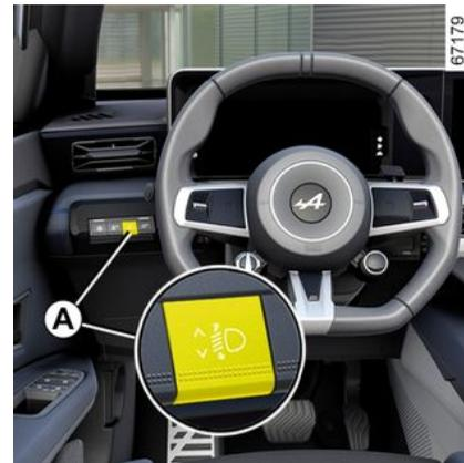
die Leuchtweitereinstellung mit dem Schalter **A** an die Ladung angepasst werden.
