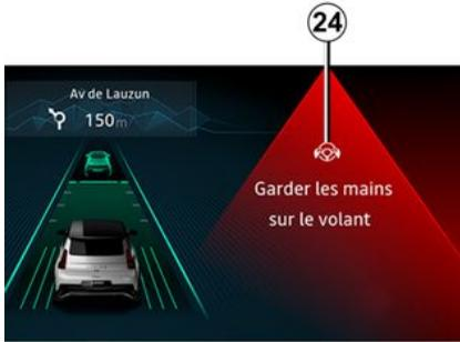
Wenn die „Spurhaltefunktion“ keine Hände am Lenkrad erkennt, wird eine mehrstufige Warnung ausgelöst:
