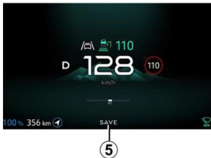
**i** Wenn Save-Modus aktiviert ist, wird die Save-Kontrollleuchte **5** auf der Instrumententafel angezeigt. Die Fahrgeschwindigkeit wird auf ca. 130 km/h begrenzt. Während der Fahrt ist es möglich, den Save-Modus vorübergehend zu verlassen, um die Motorleistung zu verbessern. Treten Sie dazu das Gaspedal fest und vollständig durch. Der Save-Modus wird wieder aktiviert, wenn Sie das Gaspedal entlasten.
