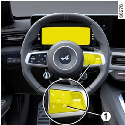
Je nach Fahrzeug können Sie mit dem Regler **1** verschiedene Anzeigen auf der Instrumententafel durchblättern und auswählen.
