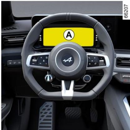
**Instrumententafel A:** Leuchtet auf, wenn die Fahrertür geöffnet wird. Informationen zum Einstellen der Helligkeit des Armaturenbretts finden Sie in den Multimedia-Anweisungen.
