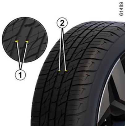
Die Reifen müssen in gutem Zustand sein und das Profil ausreichend Tiefe aufweisen; Reifen, die die technische Abteilung genehmigt hat, verfügen über Warnstreifen **1**; das sind **an mehreren Stellen**
