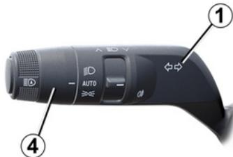
Die Beleuchtung erlischt automatisch, wenn die Fahrertür geöffnet oder das Fahrzeug verriegelt wird, oder eine Minute nach dem Ausschalten des Motors.
