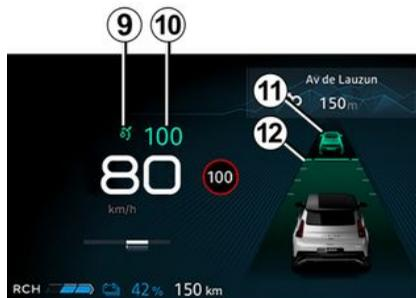
9. Kontrolllampe für den adaptiven Tempomaten mit Stop and Go-Funktion
