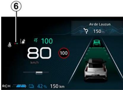
Wenn bei geschlossenen Türen die Zündung eingeschaltet wird, erscheint etwa 60 Sekunden lang die Grafik 6 an der Instrumententafel. Dies informiert den Fahrer jedes Mal über den Anlegestatus der einzelnen vorderen Sicherheitsgurte, wenn:
