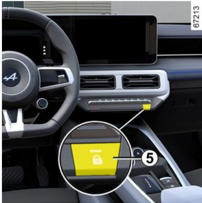
Der Schalter **5** steuert gleichzeitig die Türen und die Gepäckraumklappe.
