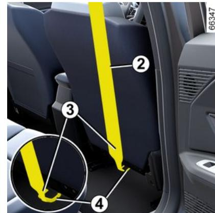
Befestigen Sie den Haken **3** an dem oberen Riemen **2** des Rings **4**,
