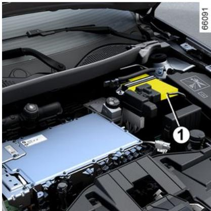
Die 12-V-Batterie liefert Energie für den Betrieb der Fahrzeugausrüstung (Scheinwerfer, Scheibenwischer, Audiosystem usw.) und bestimmter Sicherheitssysteme, wie zum Beispiel Bremsunterstützung.
