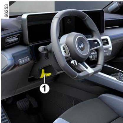
Den Hebel 1 senken und das Lenkrad in die erforderliche Position bringen.
