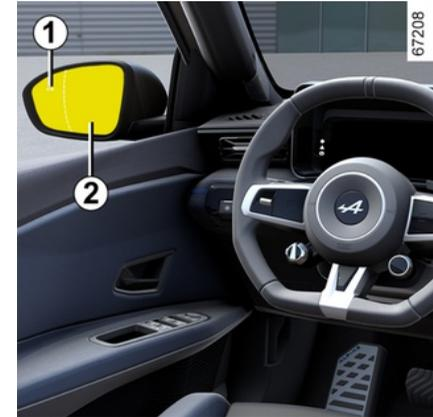
Wenn eine Tür geöffnet und ein sich bewegendes Objekt erkannt wird, wird die Warnleuchte **1** im Außenspiegel **2** angezeigt und, je nach Fahrzeugausführung, die Ambientebeleuchtung der Vordertür eingeschaltet.
