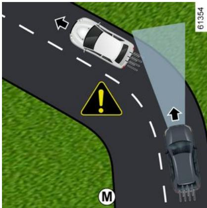
Wenn Sie in eine Kurve einfahren oder an einer Kreuzung abbiegen erkennt das Radar bzw. die Kamera das vorausfahrende Fahrzeug möglicherweise vorübergehend nicht (Beispiel **M**).
