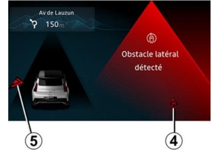
Beim Fahren mit einer Geschwindigkeit von mehr als ca. 70 km/h, bei Annäherung an eine (durchgezogene oder unterbrochene) Linie und der Gefahr eines Zusammenstoßes mit einem Fahrzeug, das sich im roten Winkel **D** befindet und in die gleiche Richtung fährt, oder mit einem Fahrzeug, das sich auf einer angrenzenden Fahrspur, die sich im Erfassungsbereich **E** befindet, schnell von hinten nähert, greift das System ein:
