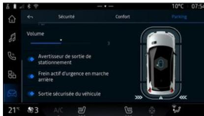
Zum Aktivieren oder Deaktivieren der Funktion über den Multimedia-Bildschirm **1** die Welt „Fahrzeug“, anschließend „Fahrassistent“ und schließlich „Parkplatz“ wählen. Aktivieren Sie „Aktive Notbremsung hinten“.
