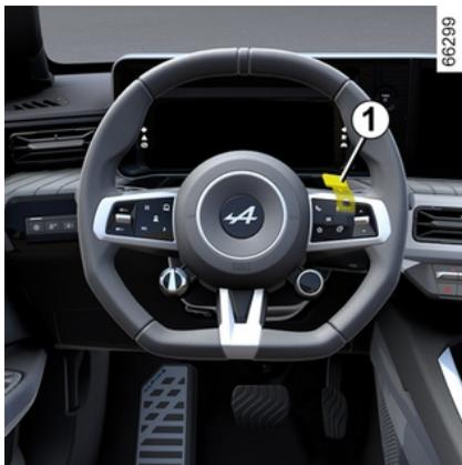
Das Standstartverfahren (Launch Control) ist eine Funktion, die es ermöglicht, das Fahrzeug bei optimaler Bodenhaftung mit Höchstgeschwindigkeit zu beschleunigen.
