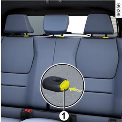
Klappen Sie die Sitzbank nach vorne, heben Sie die Kopfstütze so weit wie möglich an, drücken Sie die Taste **1** und bauen Sie die Kopfstütze aus.
