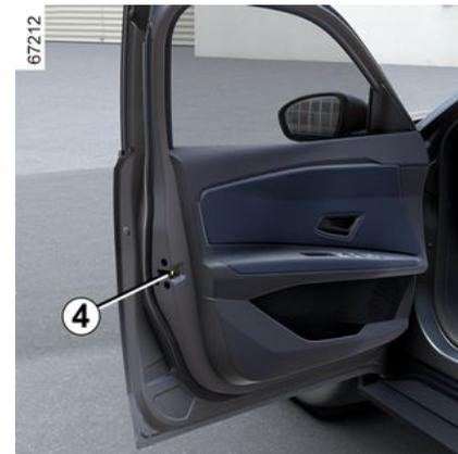
Drehen Sie bei geöffneter Tür die Schraube **4** (mit dem Ende des Schlüssels) und schließen Sie die Tür.
