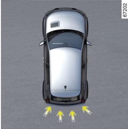
Als Ergänzung zu der Funktion „Parkassistent“ → 292 und anhand der Informationen der vier zentralen Sensoren, die sich am Heck des Fahrzeugs befinden, erkennt das System feste Hindernisse, die sich hinter dem Fahrzeug befinden. Wenn eine erhebliche Kollisionsgefahr besteht, veranlasst das System automatisch eine Bremsung des Fahrzeugs.
