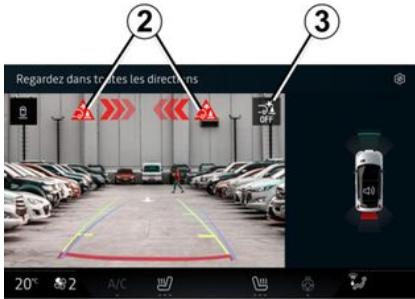
Wenn das Fahrzeug mit einer vom System erkannten Anhängerzugvorrichtung ausgestattet ist und ein Anhänger angekuppelt wurde, wird die aktive Notbremse im Rückwärtsgang automatisch deaktiviert und die folgende Meldung „Anhänger: Parksensoren nicht verfügbar“ erscheint in der Instrumententafel zusammen mit der
