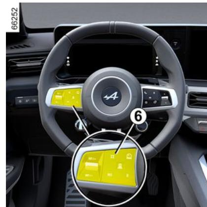
So passen Sie den Sollwert des Geschwindigkeitsbegrenzers oder des adaptiven Geschwindigkeitsreglers an die erkannten Geschwindigkeitsbegrenzungen an: Drücken Sie kurz den Schalter 6, um die Geschwindigkeit des Fahrzeugs an die auf dem letzten erkannten Geschwindigkeitsbegrenzungsschild angezeigte Geschwindigkeitsbegrenzung anzupassen.
