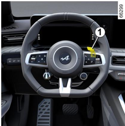
Wenn Sie die „OV“-Taste **1** am Lenkrad drücken, steigert der Motor vorübergehend die Leistung und erhöht die Beschleunigung des Fahrzeugs (Boost).
