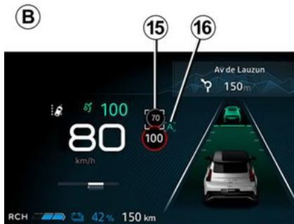
Mithilfe der Kamera, der Funktion „Verkehrszeichenerkennung“ → 242 und der Karten, begrenzt das System automatisch die Geschwindigkeit des Fahrzeugs, bis das nächste Verkehrszeichen mit Geschwindigkeitsbegrenzung **15** erkannt und passiert wird.
